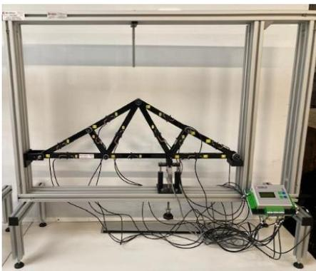
*Treillis modulable (fermette, poutre de Warren) instrumenté de jauges avec mesure de déformations, capteurs de déplacement, avec affichage en temps réel. Charges applicables en différents nœuds,*
