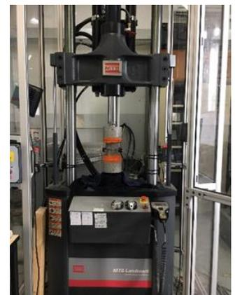
*Presse de grande précision 10 kN - 100 kN (flexion, traction, compression, caractérisation des bétons fibrés notamment)*
